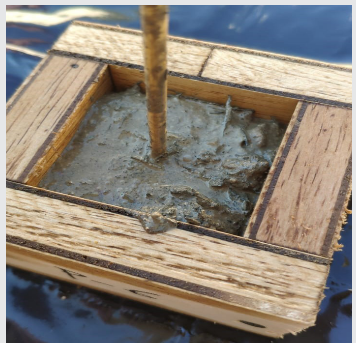
Figura 9. Colocación manual del material con un elemento de madera para darle uniformidad al llenado del molde.
