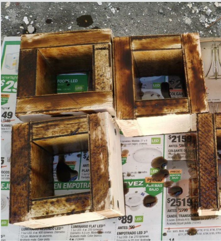
Figura 2. Aplicación de aceite quemado a los moldes de madera.
